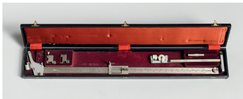
Slika 16. Polarni koordinatograf. Proizvođač „Geomehanika“ Zagreb. Područni ured za katastar Bjelovar
