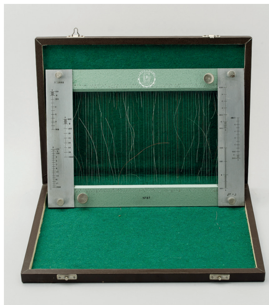
Slika 15. Nitni planimetar. Proizvođač „Geomehanika“ Zagreb. Područni ured za katastar Bjelovar.
